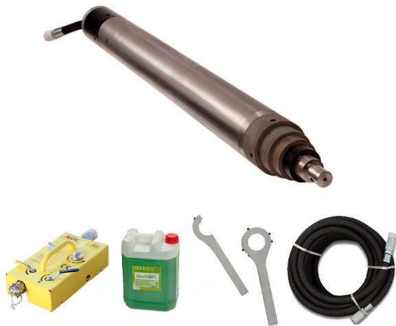
Topo neumático con servo control por medio de una palanca en el lubricador. Debido a su reducido tamaño y peso, su uso principal se encuentra en el campo de las conexiones eléctricas y de telecomunicaciones, especialmente para la instalación de tuberías de PE o PVC de 63 mm.
