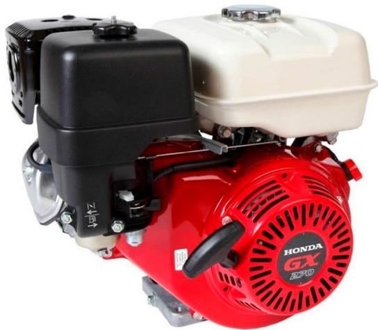
Motor estacionario de 4 tiempos de 9 HP, con sistema OHV (válvulas a la cabeza), de eje horizontal con arranque manual y alerta de aceite que hace detener el equipo en caso de bajo nivel de aceite. El GX270 presenta un nuevo diseño con más potencia, un funcionamiento más silencioso, menor consumo de combustible y emisiones más bajas.
